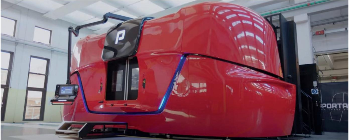
Die 2005 entwickelte PORTACENTER ist die erste serienmäßig gebaute Werkzeugmaschine mit 3 unabhängigen Spindeln, sie ist dreimal so produktiv wie ein Bearbeitungszentrum und flexibler als eine Transfermaschine (Werkstückwechsel in weniger als 15 Minuten).
